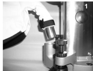
**Anmerkung.** Beim Entleeren des Staubsacks den Sack komplett mit Staubrohr entfernen, Reißverschluss öffnen und Inhalt ausleeren.
