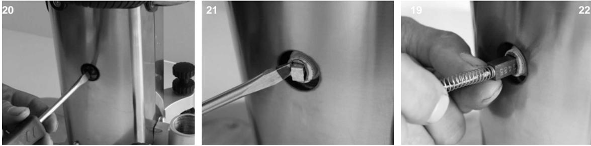
Die Kohlenbürsten haben die Aufgabe, den Strom über den drehenden Kollektor an den Anker zu leiten. Es gibt zwei Kohlenbürsten: Sie sollten regelmäßig kontrolliert und nach ca. 100 Stunden Normalbetrieb paarweise ausgetauscht werden.
